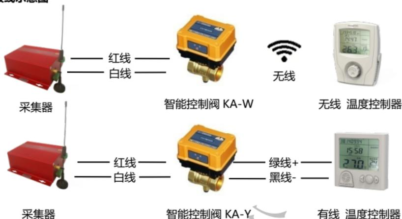
注：M-Bus 总线（采集器与控制阀之间的红线及白线）为无极性连接；控制阀与有线温控器的单总线连接要区分正负极（绿线左、黑线右），详细参照有线室内温控器说明书；外供电产品，电源线参照产品线缆标签连接。
